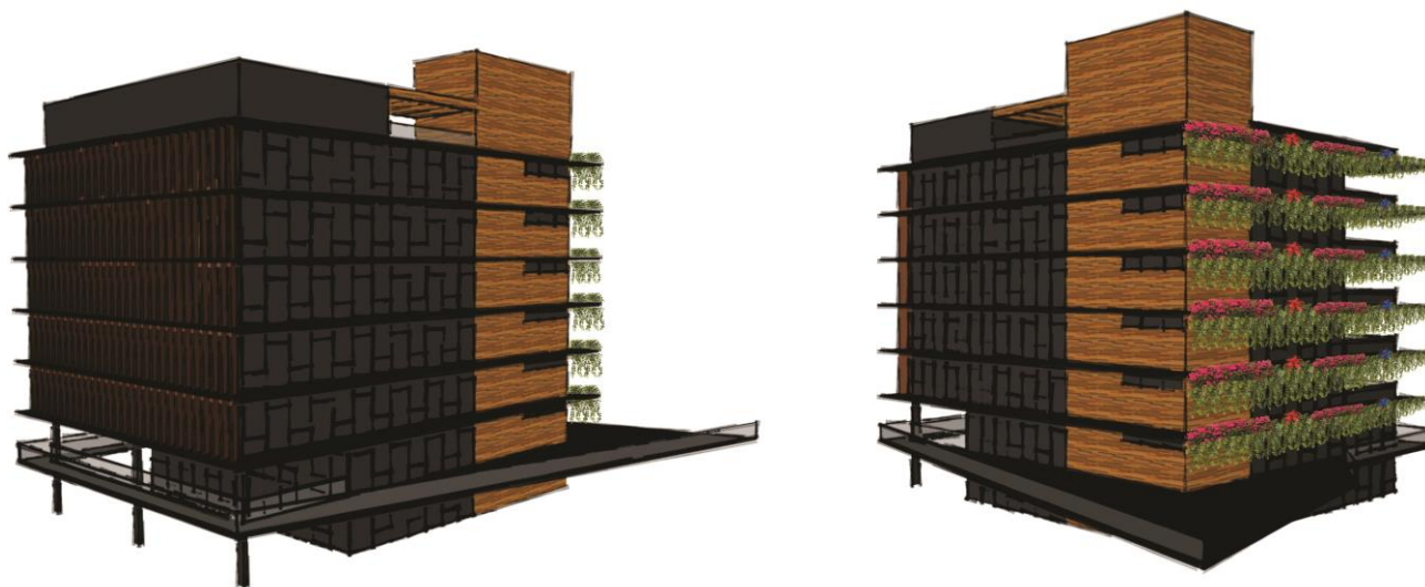
Figura 30. Composição dos brises e plantas ornamentais na fachada.
