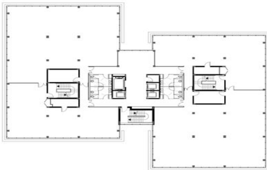
Figura 7. Planta baixa Thales, distinguindo os dois volumes e seu núcleo central.
