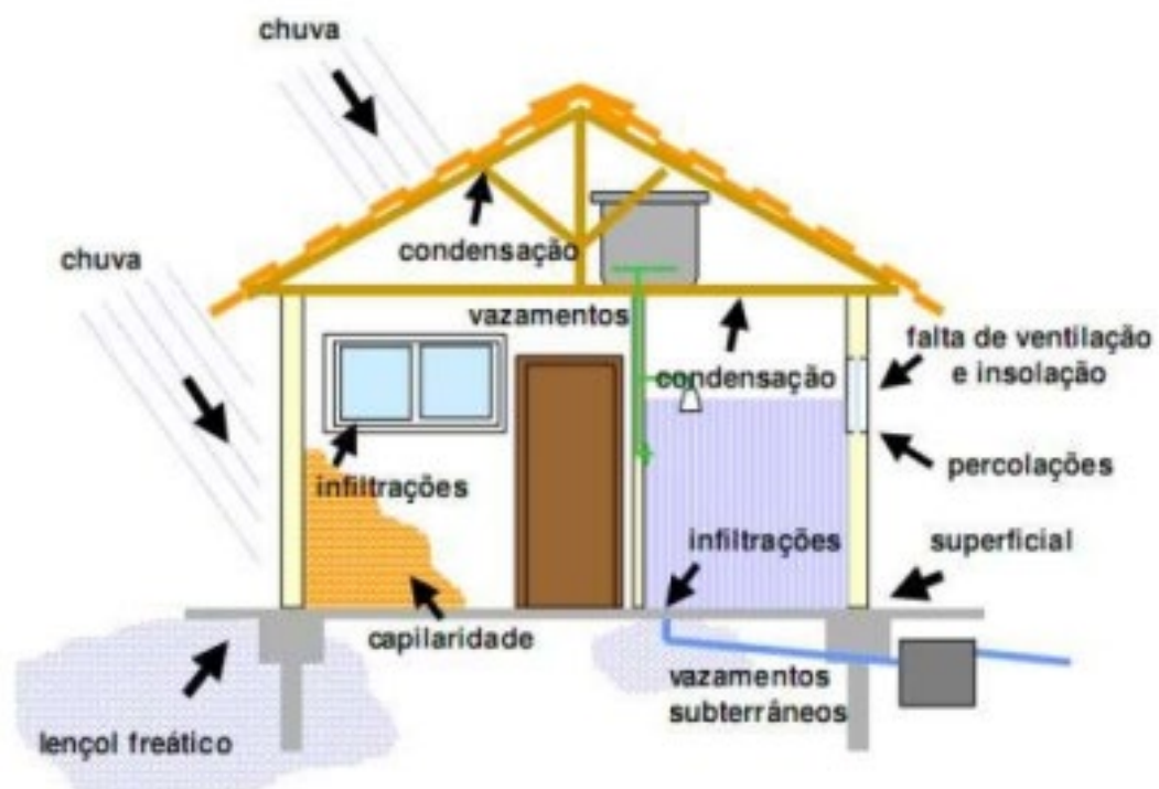
Figura 2: Causas de mancha em uma edificação. Fonte: Andrade, s.d. Adaptado por (Miranda e Andre).
