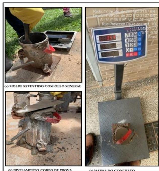
Figura 15 – Preparo de moldes e pesagem de corpos de prova para obtenção de massa específica (Autoria Própria, 2021).
