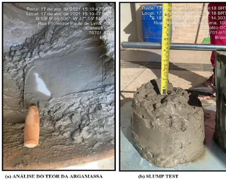
Figura 14 – Ensaio de slump test e análise do teor de argamassa conforme método IPT (Autoria Própria, 2021).
