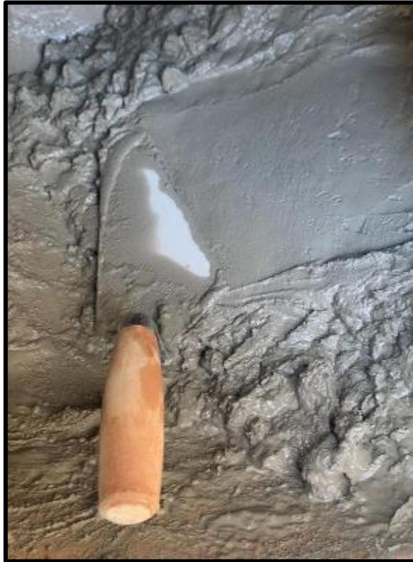
Figura 17 – Análise de teor de argamassa conforme método IPT para traço rico (Autoria Própria, 2021).
