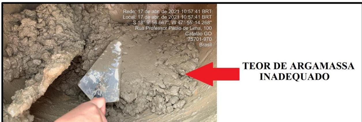
Figura 12 – Análise do teor de argamassa conforme método IPT (Autoria Própria, 2021).
