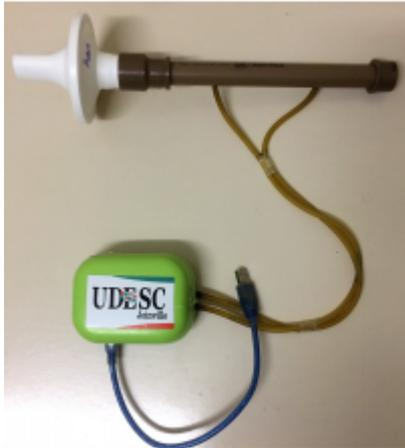
Figura 4. Dispositivo PITACO.
