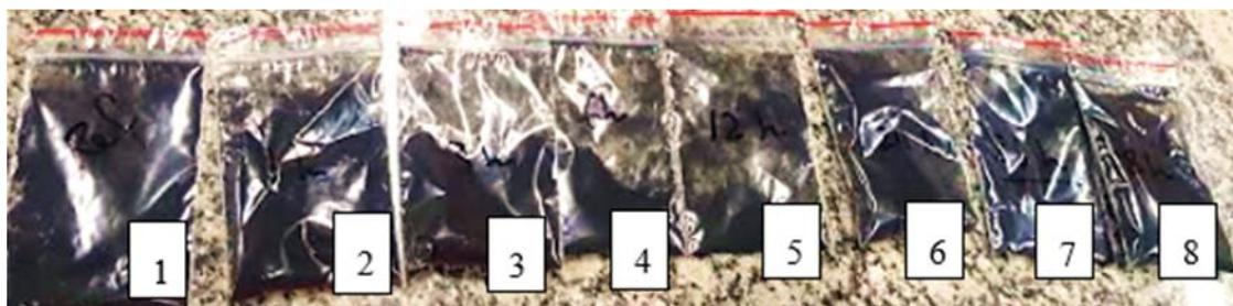
Legenda: 1 – Amostra de referência; 2 – 1 hora de exposição à irradiação UV; 3 – 3 horas de exposição; 4 – 6 horas de exposição; 5 – 12 horas de exposição; 6 – 24 horas de exposição; 7 – 36 horas de exposição; 8 – 48 horas de exposição. Fonte: Autor, 2021.
