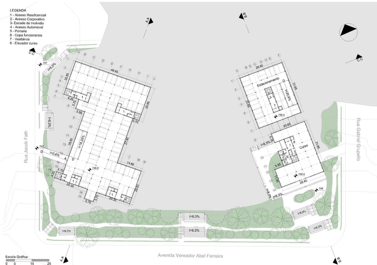
O primeiro subsolo segue o mesmo padrão do segundo subsolo, porém existente uma separação de usos na Torre 3. Sendo uma parte destinada a estacionamento, e a outra é onde ocorrem tanto o acesso residencial, quanto o acesso ao curso técnico. O estacionamento voltado para as torres 1 e 2 possui 78 vagas para carro e 22 vagas para moto, enquanto o estacionamento voltado para torre 3 possui 25 vagas para carro, assim totalizando 103 vagas para carros neste pavimento.
