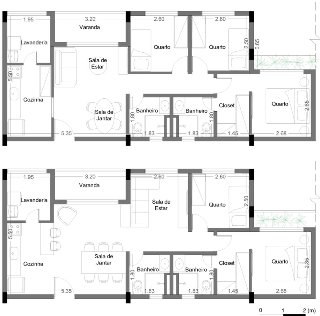
O apartamento tipo B possui 69,8m<sup>2</sup> e duas possibilidades diferentes de layout, sendo possível que o morador opte entre dois ou três dormitórios, e cozinha integrada, sendo que o layout com dois dormitórios fornece uma área social ampliada.
