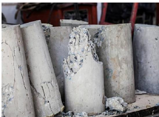
(a) Concreto Fraturado
