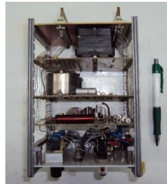
Figura 6 - Cartões dos módulos de controle - Relé BBC.
