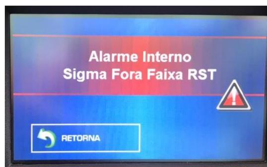
Figura 20 - Indicação de falha do *nobreak*
