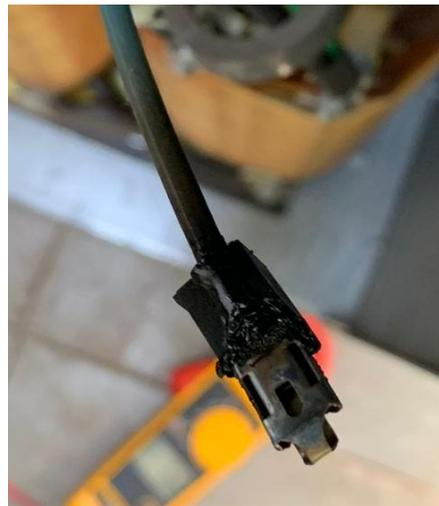
Figura 19 - Conector carbonizado
