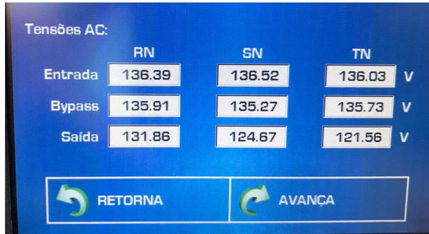
Figura 21 - Desbalanceamento de tensão na saída ano *nobreak*
