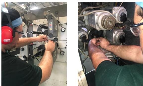
Figura 36 – Fotos no momento da auditoria da inspeção/lubrificação da bobinadeira da extrusora 02.
