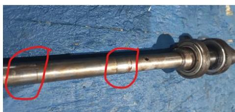
Figura 11: Desgaste do eixo do bobinador.
