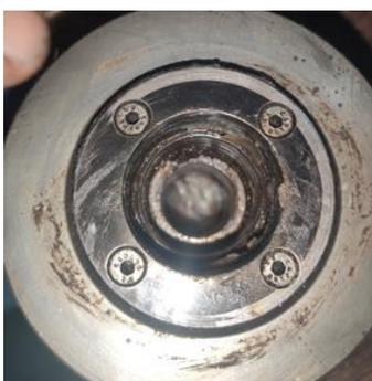
Figura 12: Desgaste do furo de ajuste com o eixo bobinador.
