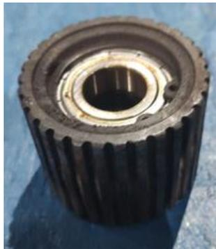
Figura 17: Desgaste dos rolamentos das polias dentadas.
