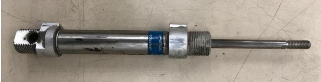
Figura 16: Cilindro pneumático com vazamento.
