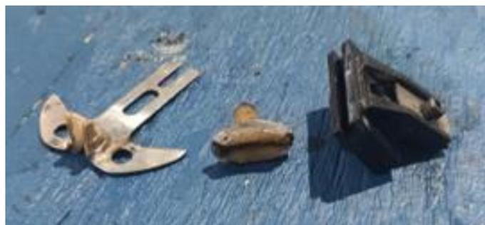
Figura 15: Desgaste do kit do carrinho guia fio.
