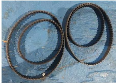
Figura 19: Correas dentadas desgastadas.
