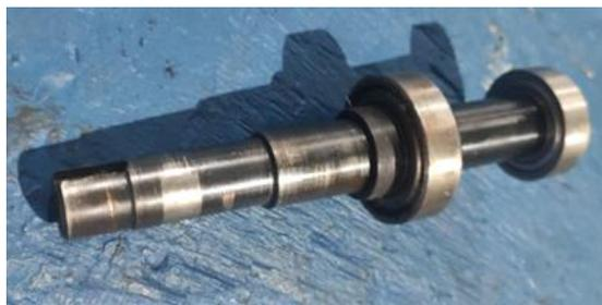
Figura 20: Rolamentos do eixo central desgastados.
