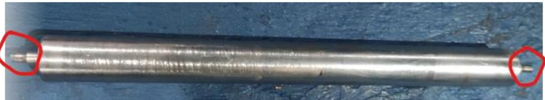
Figura 14: Desgaste na ponteira do eixo compactador.
