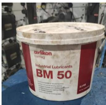
Figura 30 – Graxas usadas nas bobinadeiras.
