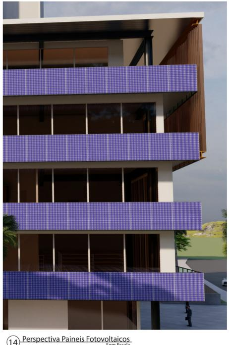
14 Perspectiva Painéis Fotovoltaicos Sem Escala
