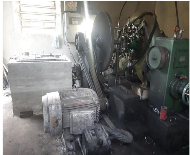
Figura 10: Gerador assíncrono conectado a turbina.
