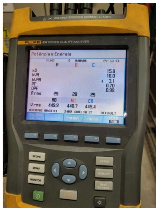
Figura 20– Dados coletados potência ativa, reativa e fator de potência Fabricator ES410IC- Fonte: Próprio Autor
