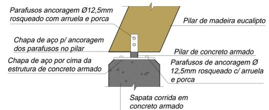
**Pilar - Vista do encaixe no piso ESCALA 1/25**
