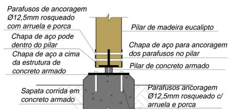
**Pilar - Corte do encaixe no piso ESCALA 1/25**
