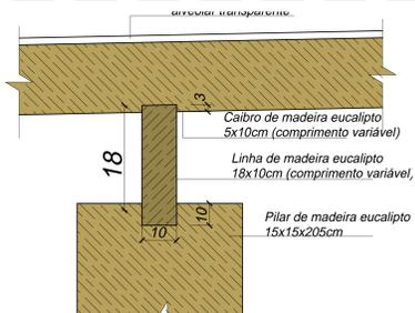
**Pilar - Encaixe Pergolado SEM ESCALA**
