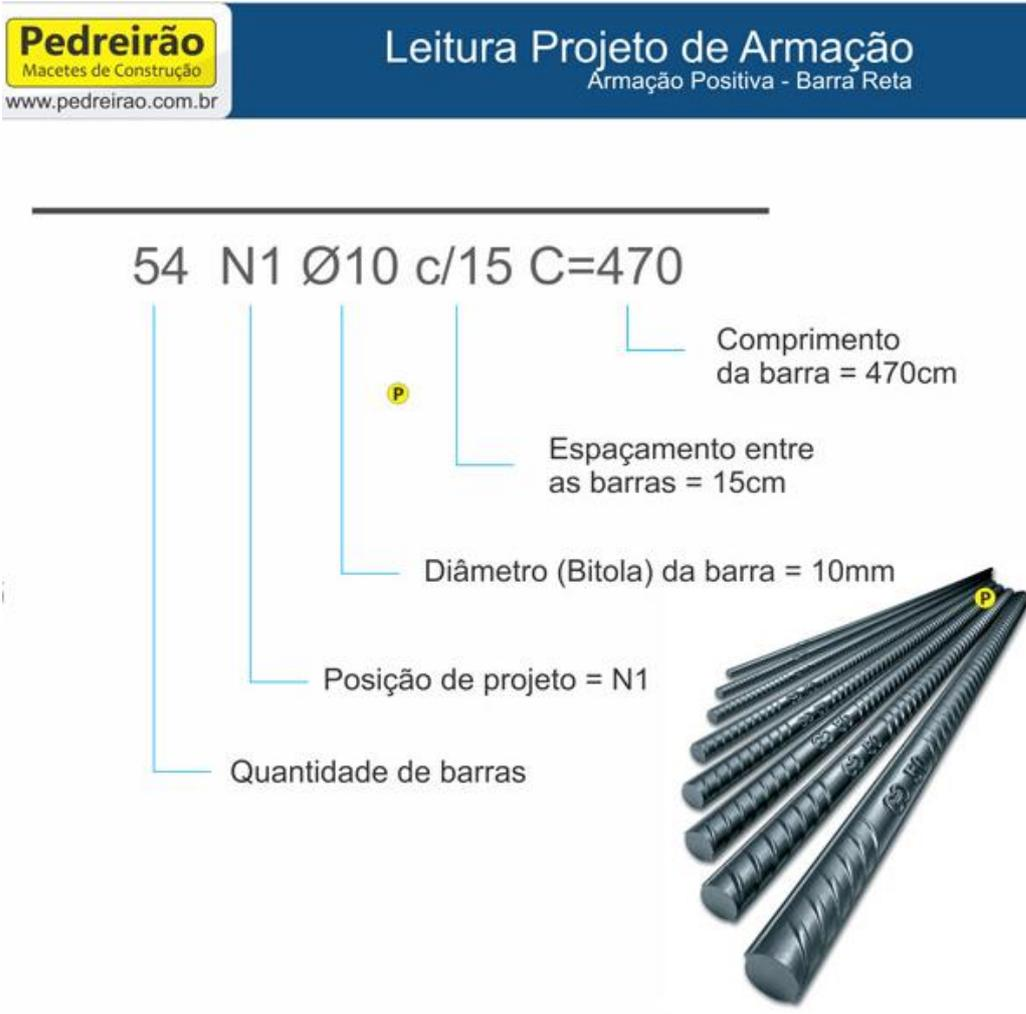
**Figura 6** - Detalhamento projeto estrutural
