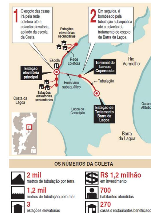
Fig. 50 - Esquema Saneamento Costa da Lagoa
