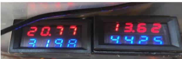
obtivemos na entrada 20,77V corrente de 3,98A , o que nos dá uma potência de 66,42W, e na saída temos 13,62V por 4,425A, uma potência de 60,27W e um rendimento com a nova configuração de 90,73%.o pequeno ganho deveu-se ao fato de o diodo original ser um diodo rápido, e o que coloquei foi um diodo *schottky*, com menor queda de tensão, e melhor rendimento que o original. Isso demonstra como pequenas mudanças no projeto podem melhorar o desempenho.
