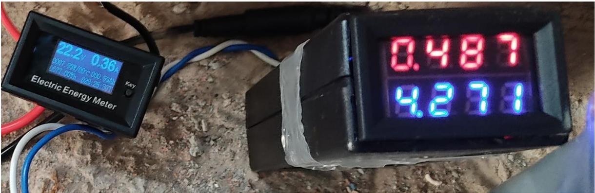
Após os testes foi identificado um aquecimento considerável na placa pois ela estava encerrada em uma caixa plástica fechada e com pouca ventilação, e após algum tempo de funcionamento ocorreu a queima do circuito chaveador por esse superaquecimento.
