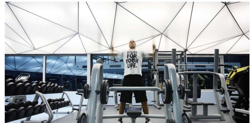
Imagem 40 - Triângulos retroiluminados permitem uma iluminação difusa e agradável
