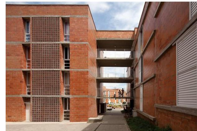
O sistema construtivo utilizado na construção do projeto foi a alvenaria estrutural, com o uso de bloco cerâmico estrutural aparente, devido ao seu bom desempenho termoacústico, gerando pouca manutenção e apresenta menor custo. Além disso, os edifícios não possuem vigas, o que permitem aberturas até o teto. (ARCHDAILY, 2021)
