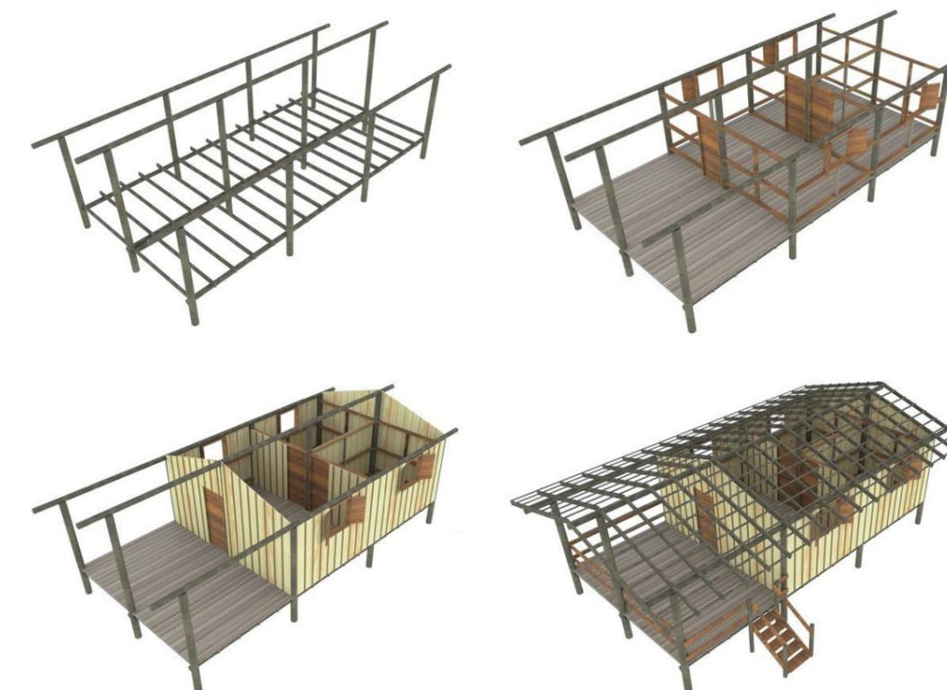
Figura 31: Diagramas de concepção estrutural
