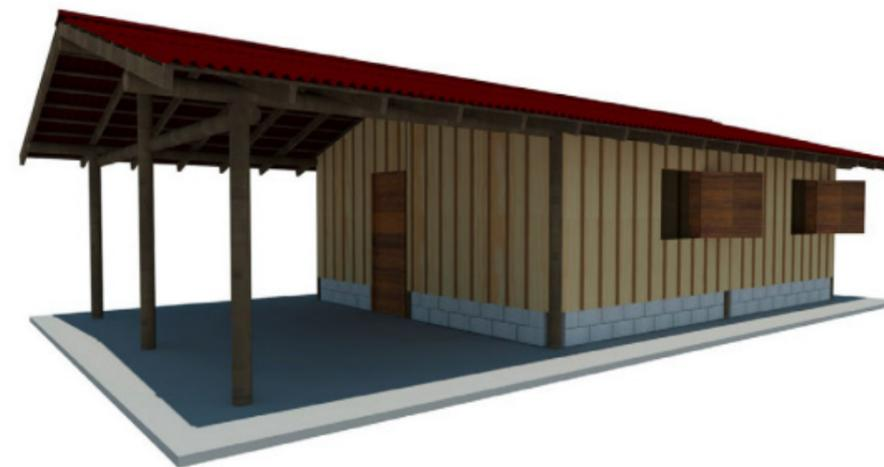
\*Nas implantações térreas é construído uma base de alvenaria convencional para auxiliar na questão estrutural. São 3 fiadas de tijolos, sendo uma uma enterrada e duas externas.
