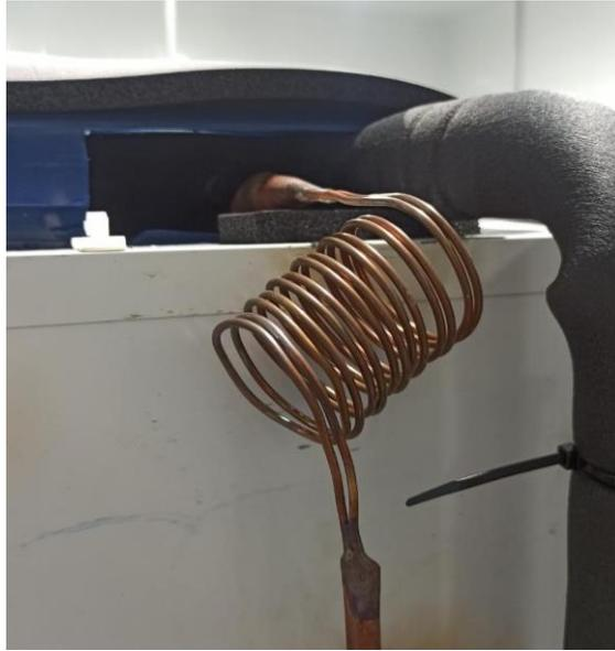
**Figura 13:** Resfriador de água com tubo capilar. (Fonte: O AUTOR, 2021).
