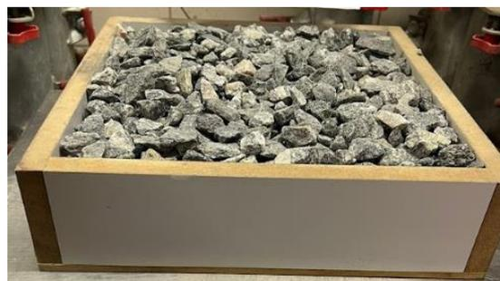
**Figura 3: brita de RCC e caixote de madeira impermeável**
