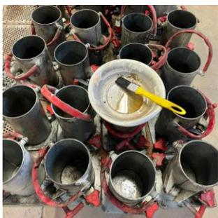
**Figura 6: moldes prismáticos**
