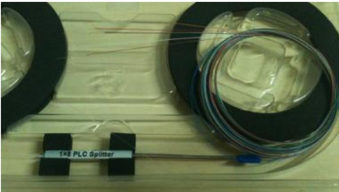
Figura 28 – Divisor óptico passivo
