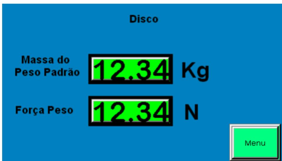
Figura 15 - Tela para monitorar o valor da massa medida pela célula de carga (autoria própria).
