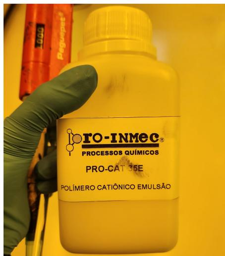
A proporção utilizada para o experimento foi de 1:10 (volume/volume, sendo uma parte de polímero para 10 partes de efluente). Para o teste de bancada, a mistura de efluente com o polímero catiônico foi conduzida e controlada em Speed mixer,
