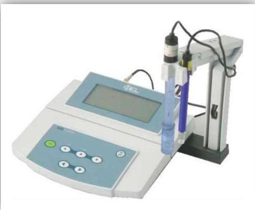
Figura 6: PHMETRO de bancada utilizado para realizar a medição do pH dos adesivos odontológicos
