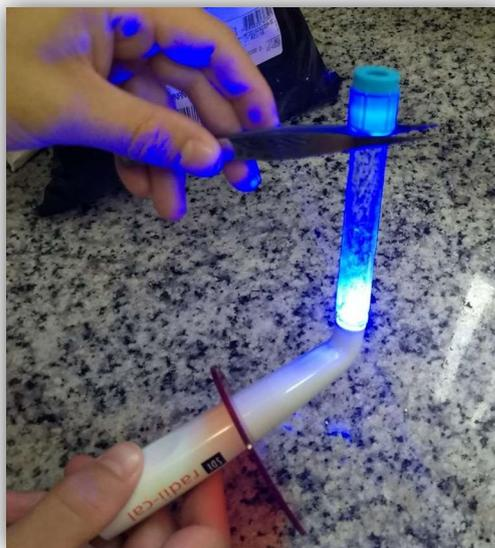
Figura 5: Método utilizado para a polimerização dos adesivos odontológicos nos tubos de ensaio
