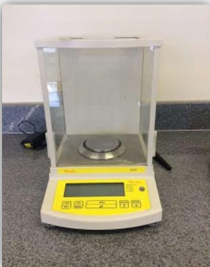
Figura 4: Balança analítica utilizada na pesagem dos adesivos odontológicos
