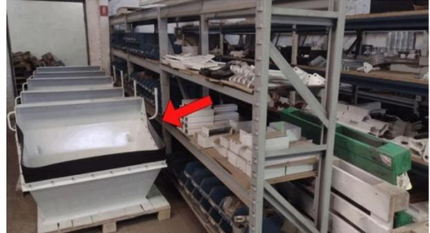
**Figura 5** - Carcaça do agitador de concreto secando após pintura no corredor do estoque. **Fonte:** Os autores (2022).
