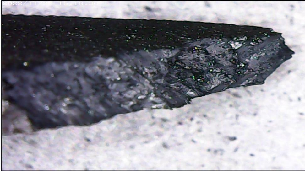
Na figura 25 está representado os corpos de prova do material AISI D6 utilizado para o ensaio de tração em condição de estrição.
