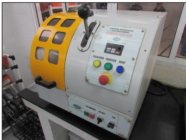
Após os cortes, foram dispostas as frações das amostras e cobertas por baquelite em uma embutidora marca Arotec, modelo Pre 30 (Figura 17).
