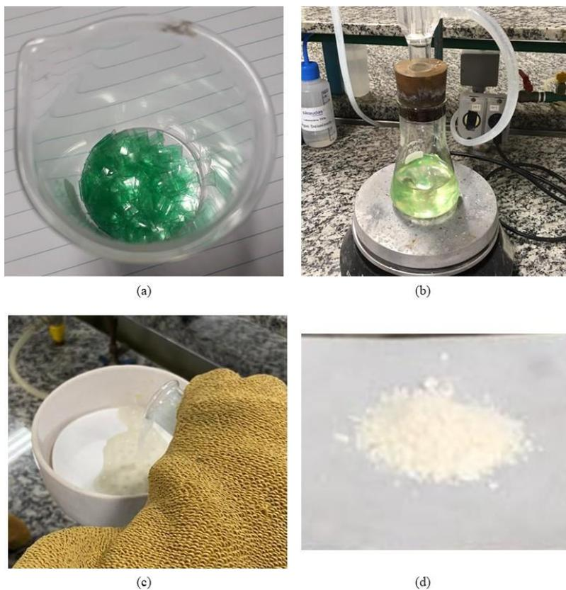
Figura 17 - Processo de reciclagem do PET: (a) Corte das garrafas; (b) PET em reação com NaOH; (c) Filtração do material obtido; (d) Material obtido.
