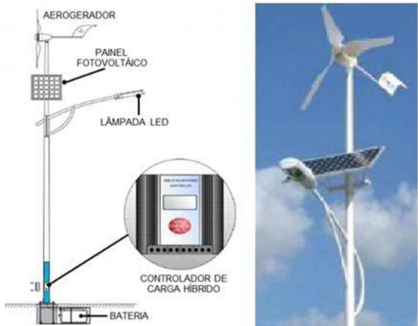
Figura 42 - Modelo de poste sustentável. Fonte: Site Eletrovento.
