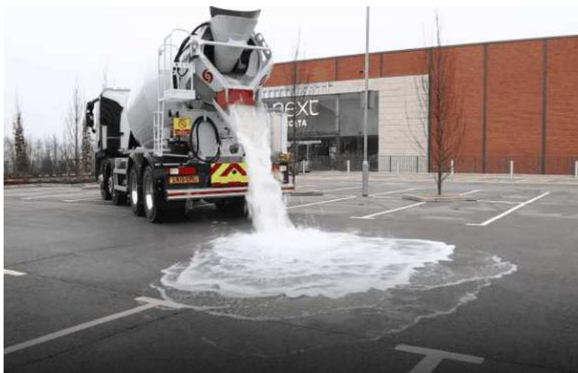
**Figura 40 - Asfalto drenante. Fonte: Site Revista Galileu.**
