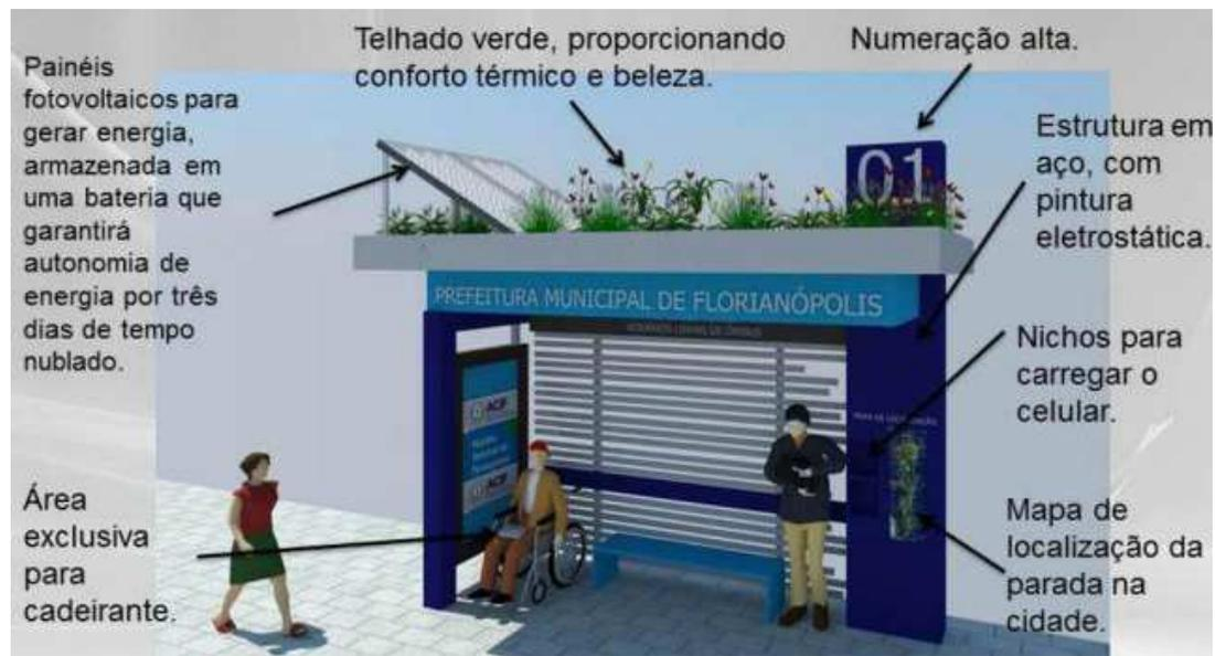
Figura 43 - Ponto de ônibus sustentável. Fonte: Site Tem Sustentável.
