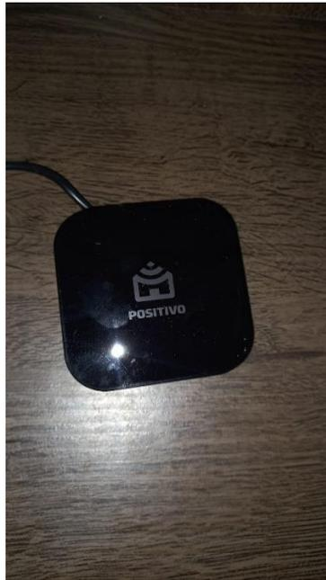
**Figura 4 - Controle universal Infravermelho**
