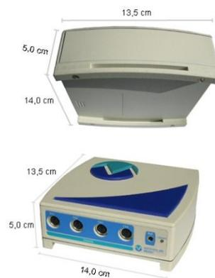
Figura 3 - Eletromiógrafo Miotool
