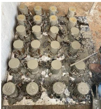
Figura 10 – Corpos de prova moldados no local para ensaio à compressão.
