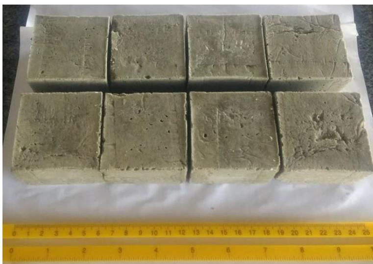
Figura 1: Amostras utilizadas para o teste de compressão mecânica: A1 (PU\_ATH\_CEM); A2 (PU\_CEM\_PVC), A3 (PU\_ATH\_CEM\_PVC).
