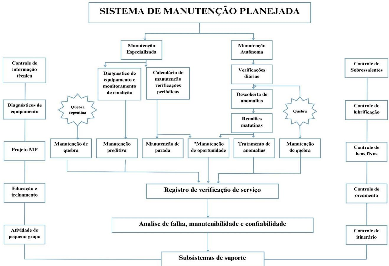
Figura 3. Esboço do sistema de manutenção planejada. Fonte: Suzuki, 1996.
