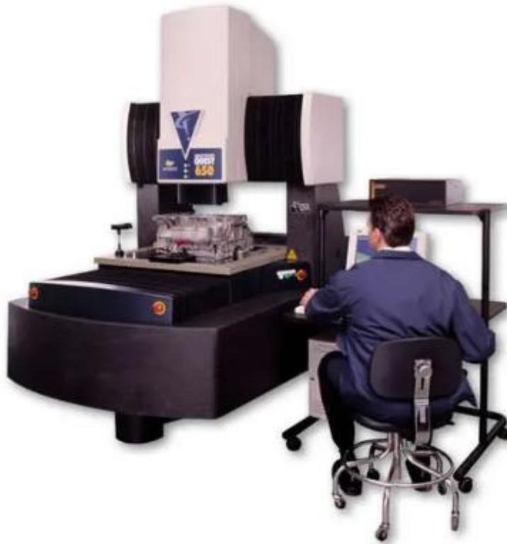
Figura ilustrativa do instrumento de medição conhecido medidor óptico tridimensional. Fonte Google imagens.
