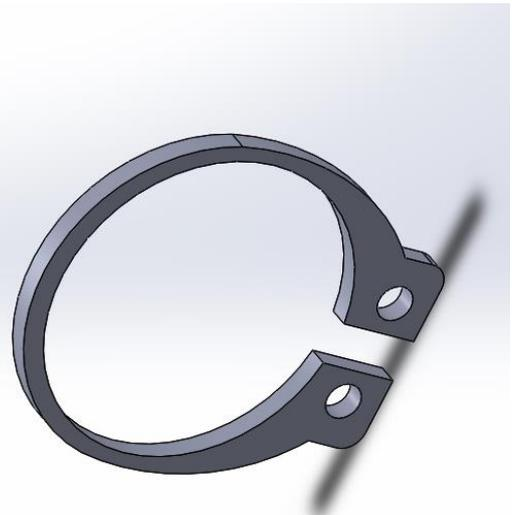
Figuras ilustrativas do item de nº 5 – Anel Elástico. Imagens retiradas do Programa Solid Works.
