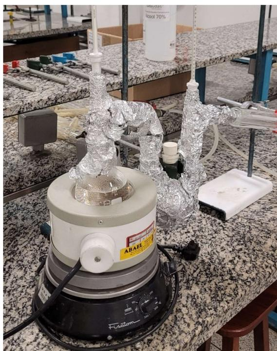
*Figura 6: Sistema de extração de arraste a vapor. Fonte: Figura do autor.*
