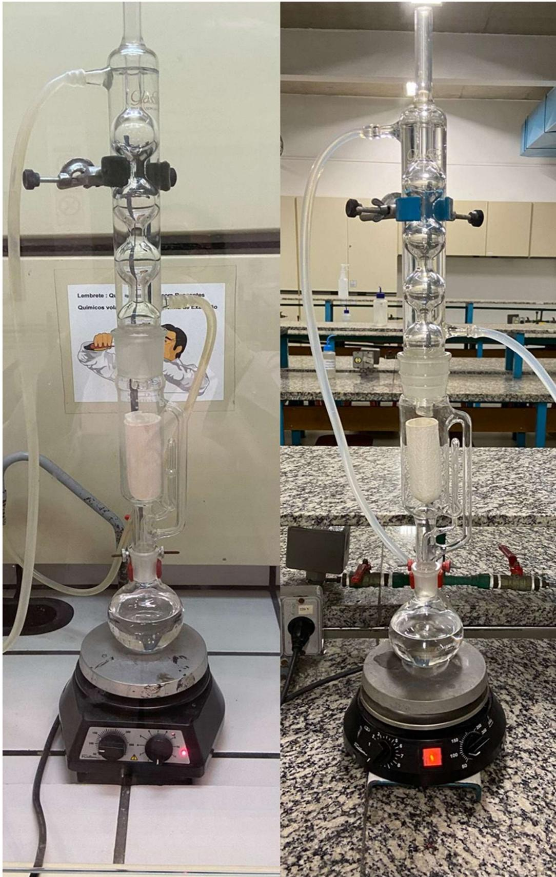
*Figura 8: Extração via Soxhlet: Hexano e Etanol. Fonte: Figura do autor.*
