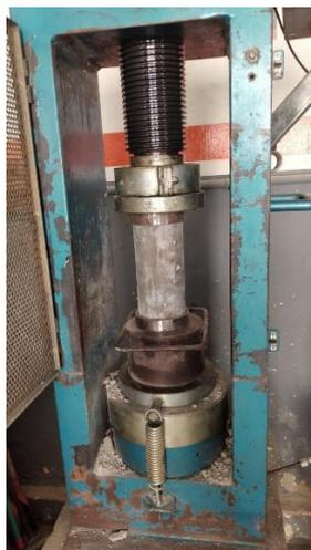
Figura 11: Ensaio de Compressão dos corpos de provas (Fonte: Autor).
