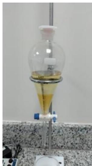
Figura 2. Separação do glicerol do biodiesel, (Fonte: Autor).
