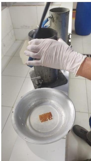
Figura 7: Passando desmoldante, (Fonte: Autor).
