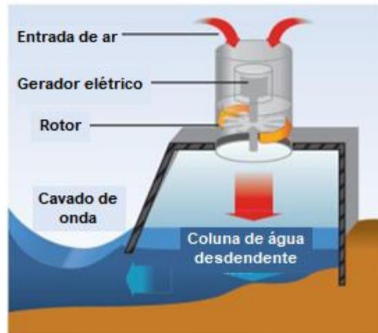
Figura 6. Conversor de coluna de água Oscilante (LEWIS, et al., 2011).
