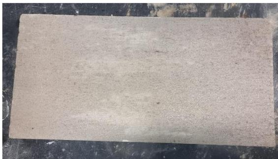
Optou-se por realizar a cura das argamassas em câmara úmida, pois quando deixadas nas condições ambientais do laboratório apareceram algumas fissuras.
