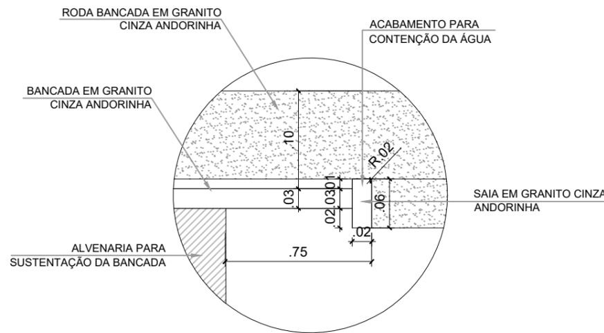
DETALHE CORTE - BANCADA GRANITO
