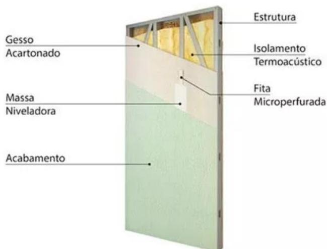
Figura 21 – Fechamento interno com chapas de gesso acartonado
