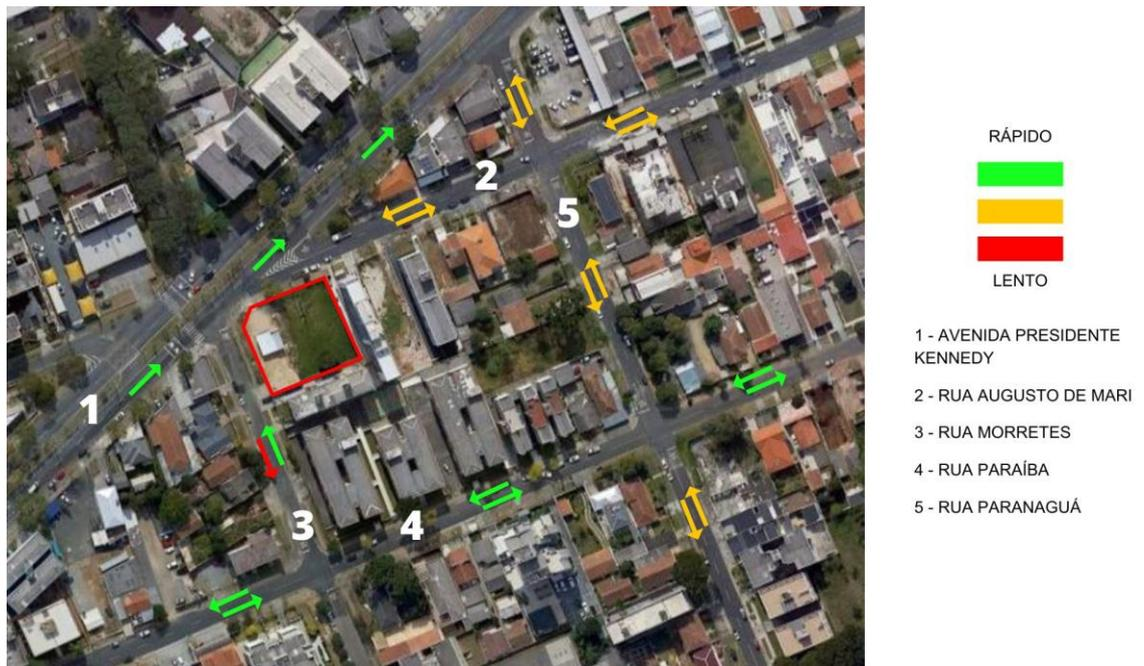
Figura 49- Fluxo de vias entorno do terreno<sup>6</sup>
