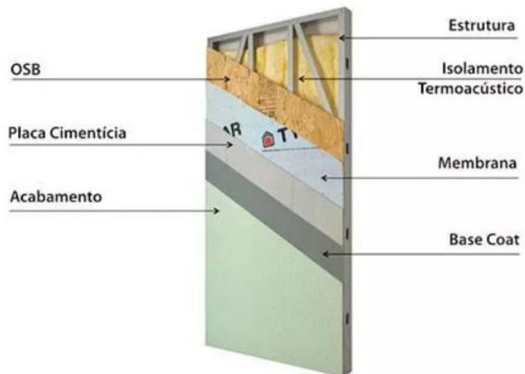
Figura 20 – Fechamento externo com placa Cimentícia
