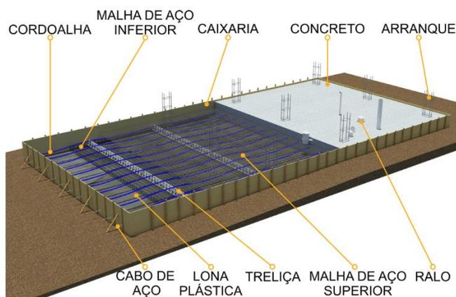
Figura 24 – Radier de concreto protendido
