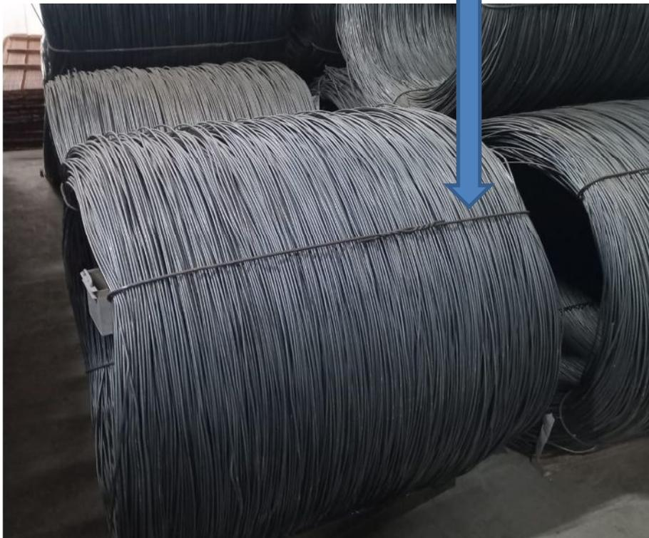
**Figura 2.2:** Bobinas de Fio-Máquina (O AUTOR).
