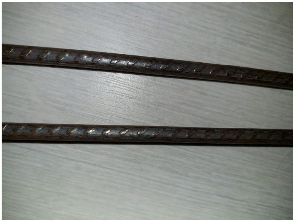
**Figura 3.1:** Amostras do aço trefilado e nervurado (O AUTOR).
