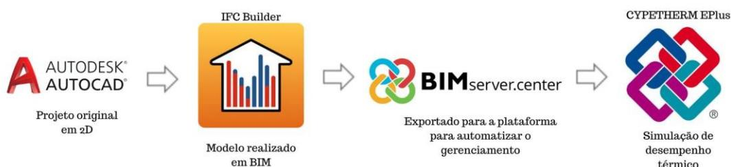
**Figura 01:** Modelo resumido da metodologia utilizada para o teste térmico.
