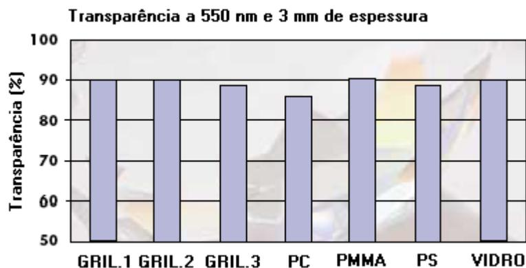
Figura 3 – Gráfico da transparência das matérias-primas utilizadas em comparação com outros materiais.
