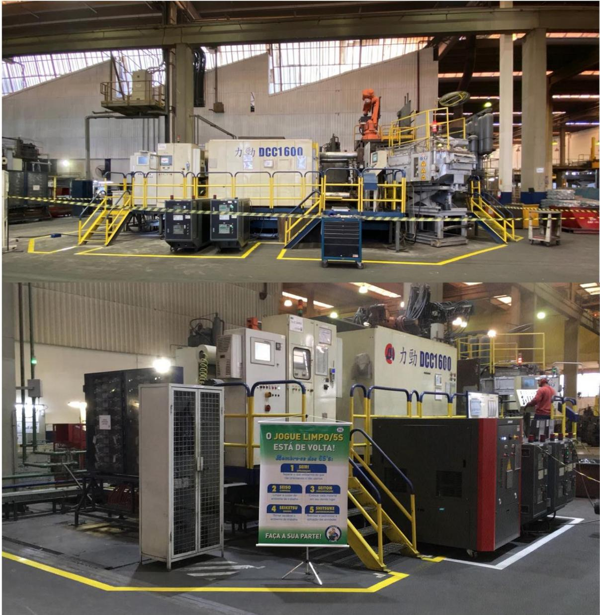
Figura 25 - Máquina pronta, finalizada com pintura e demarcações de área.
