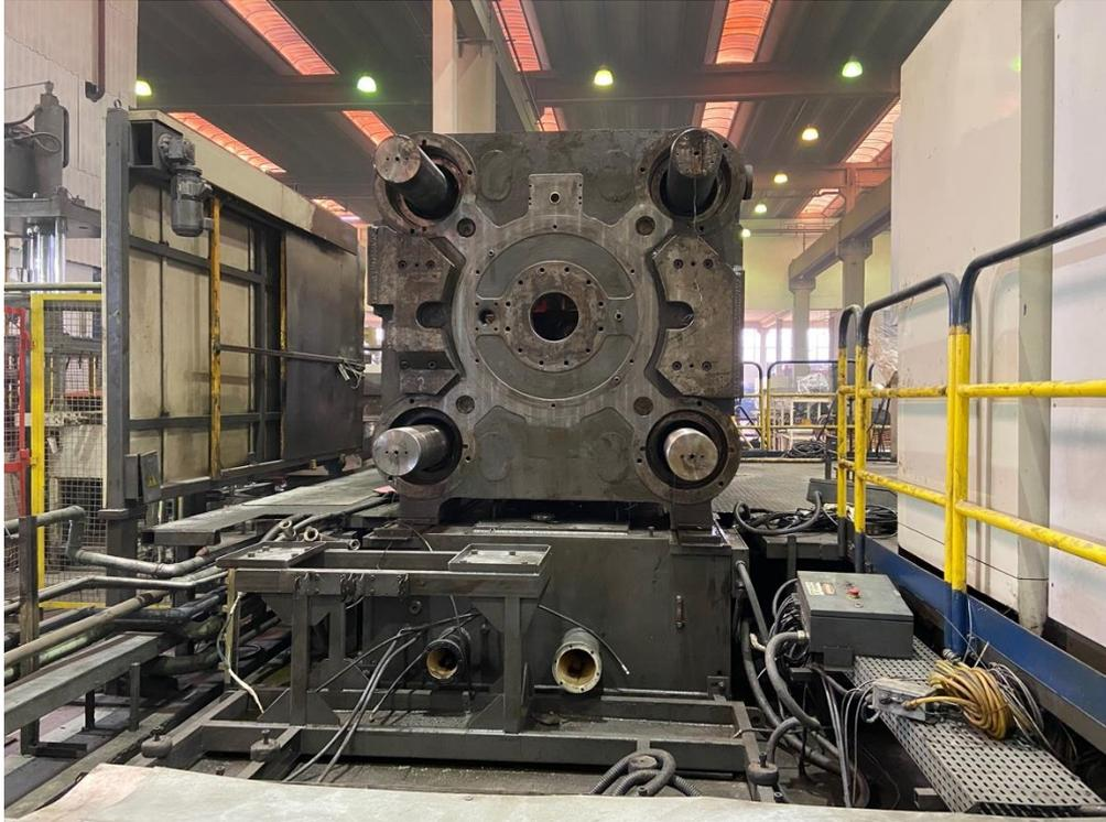
**Figura 21 - Máquina montada com base, placa traseira e 4 colunas.**
