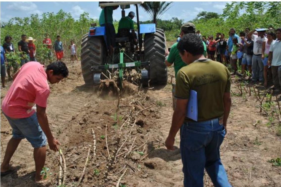
**Figura 9:** Afofador elimina o esforço de arrancar com as próprias mãos.
