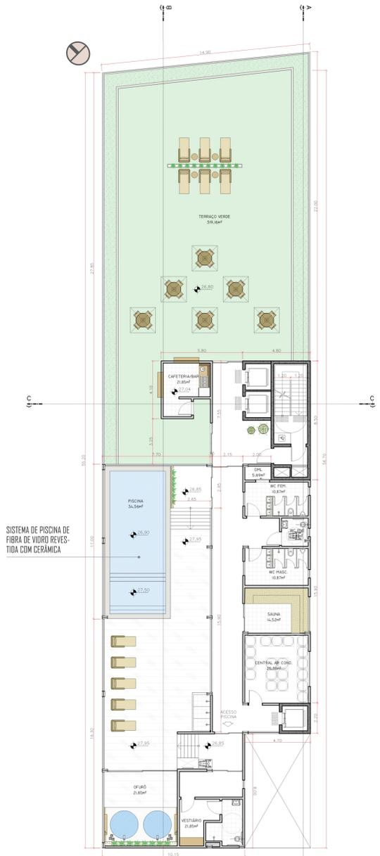
SISTEMA DE PISCINA DE FIBRA DE VIDRO REVESTIDA COM CERÂMICA
