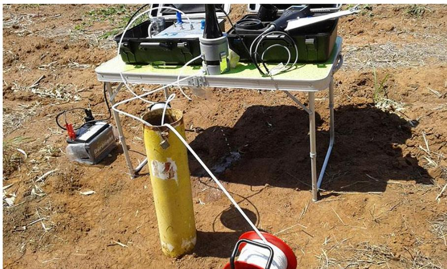
Figura 2: Equipamento de amostragem por baixa vazão (VENTURO, 2020)
