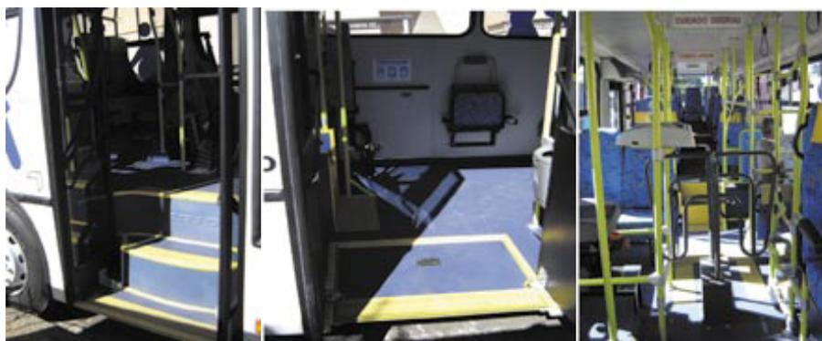
Fotos, 01, 02,03 - Interiores de ônibus sinalizados/adaptados
