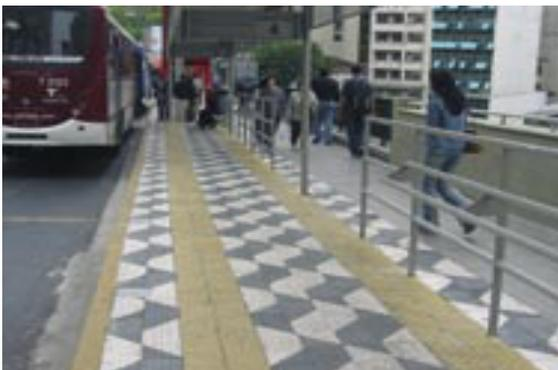
Fig 14 - Parada de transporte coletivo com faixa Orientadora.
